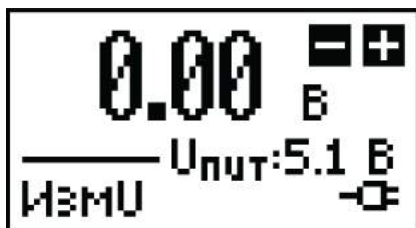
Рисунок 6.2 – Экран прибора в режиме измерения напряжения
