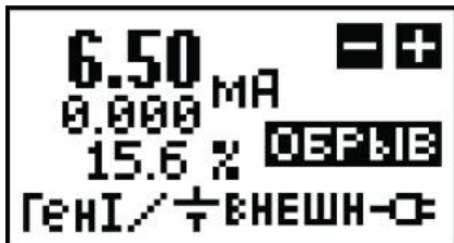
Рисунок 6.4 – Экран прибора в режиме генерации тока с плавным изменением задания
