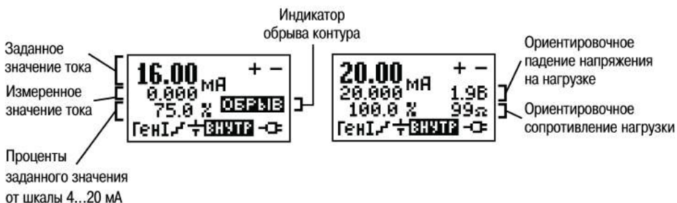
Рисунок 6.3 – Экран прибора в режиме генерации тока со ступенчатым изменением задания
