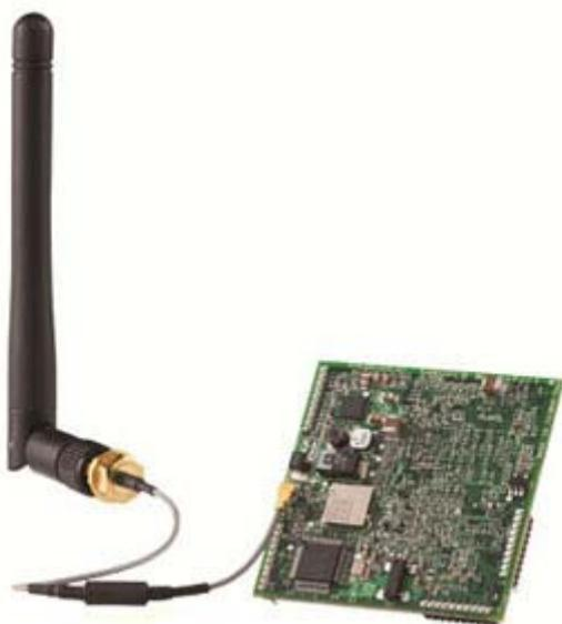
*Устройство доступа Serial-Ethernet Моха MiiNePort W1*
