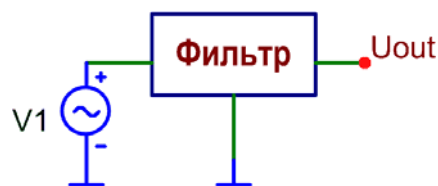
Рис.2.10 Схема для измерения характеристик фильтров
